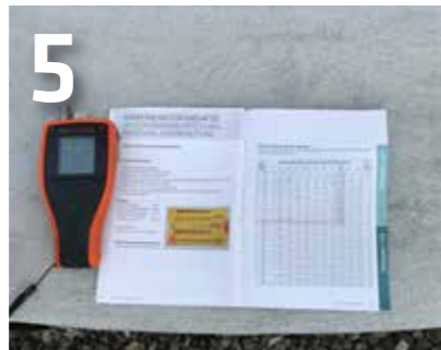
5 Ermittlung der Messwerte Haftzug, Restfeuchte und Taupunkt
